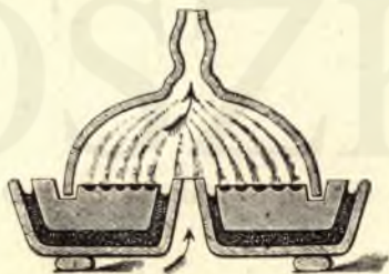
44. kép. Stainer-féle csiráztató-készülék. A légáramlás útját nyilak jelzik. (Árjegyzékből.)
