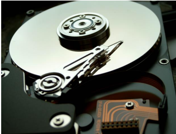
39. ábra: A merevlemez felépítése
