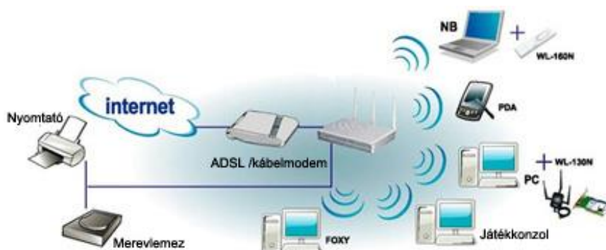
11. ábra: Wifi router kapcsolódási lehetőségei
