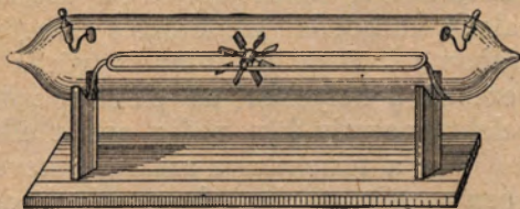
4. kép. Kerék, melyet a kathodsugarak mozgásba hoznak.
