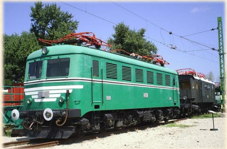
MÁV V.55. Ganz - Kandó – Ratkovszky rendszerű fázis – és periódusváltós mozdony 13
