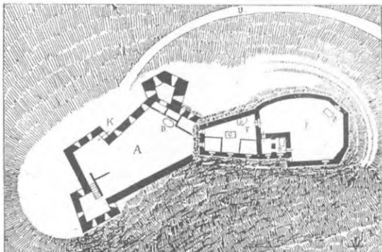
1. ábra. A siroki vár alaprajza Vargha Tivadar (felső rajz) és Kovács Béla (alsó rajz) nyomán. A – sziklavár, B – alsó vár, C – szálkőzetből kifaragott kapuvédemű, D – sziklába vágott árok, E – kút, F – a lakótorony alsó szintje („mulató”), a – sziklafolyosók, b – kazamata, c – kőfűlkék
