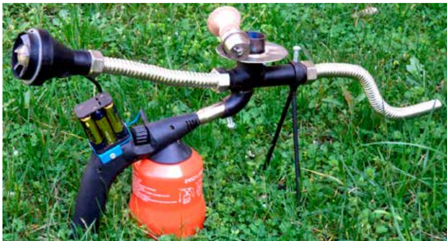
4. ábra: Az oxálsav szublimáltatáshoz használt, módosított Mohai féle készülék
