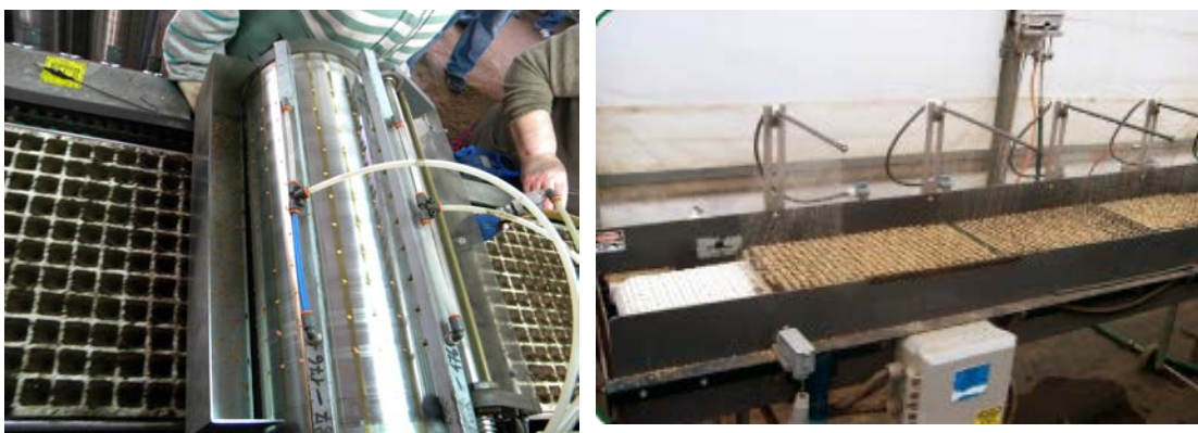
9. ábra Automatizált vetés és beöntözés (Fotó: saját felvétel)
