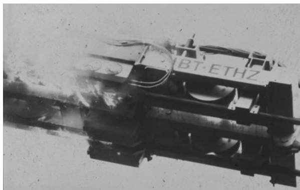
2. ábra: A kötélpályák járműveibe beépített vészfékek betétjei mintegy négy nagyságrenddel nagyobb igénybevételnek vannak kitéve, mint a vasúti kocsik abroncsfékei. Kifejlesztésükhöz eredeti nagyságban végzett kísérletek szükségesek
