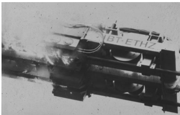
2. ábra: A kötélpályák járműveibe beépített vészfékek betétjei mintegy négy nagyságrendel nagyobb igénybevételnek vannak kitéve, mint a vasúti kocsik abroncsfékei. Kifejlesztésükhöz eredeti nagyságban végzett kísérletek szükségesek
