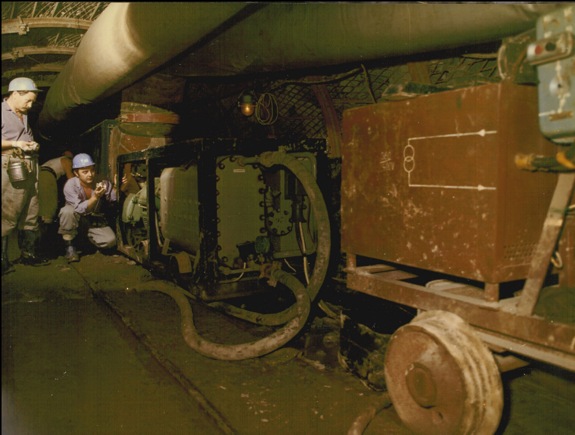
Vágathajtásnál használt levegő hűtő VK120. Jobb oldalon a csillealvázra szerelt kapcsoló berendezés.
