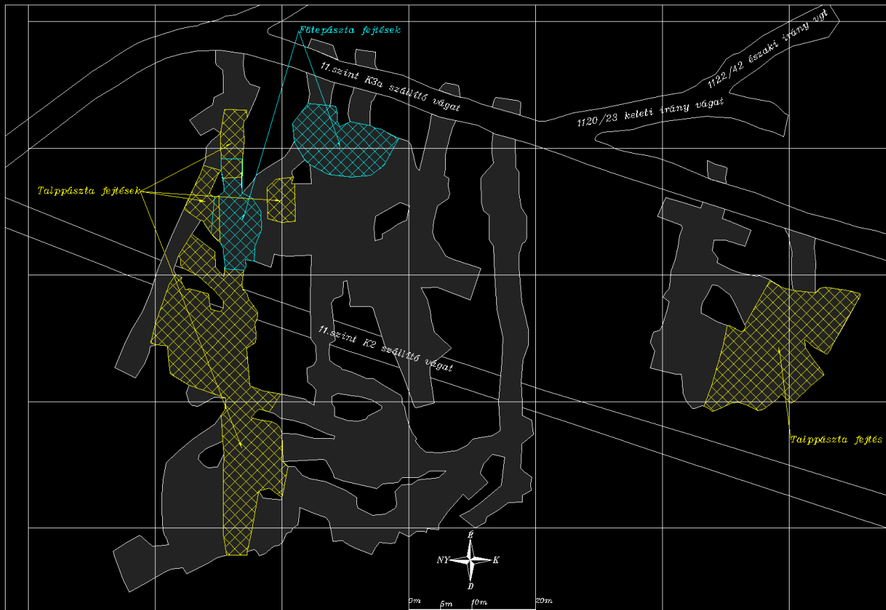
24. ábra. Talp és főtepászták egy alapvágati fejtési rendszerben.
