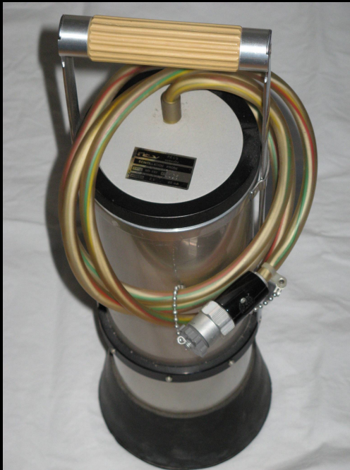
MD 497 szcintillációs gamma detektor (7 V, 40 mA.) Geometriai mérete 500mm magas 120 mm átmérő.
