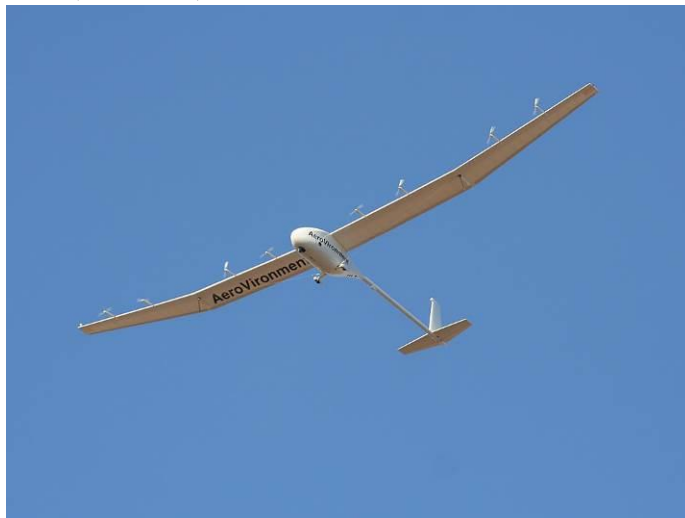
2.34. ábra. A Global Observer 'Odyssey' HALE UAV [2.19].
