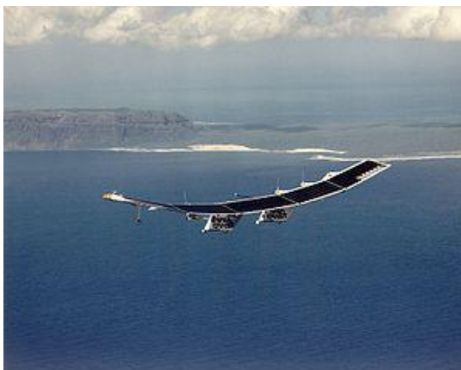
2.28. ábra. NASA Pathfinder HALE UAV [2.19].
