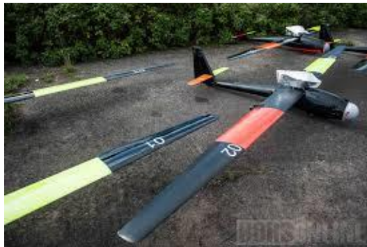
2.38. ábra. A METEOR 3MA TUAV [2.19].
