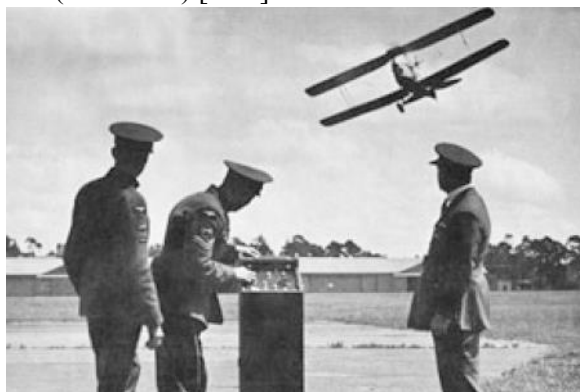
2.19. ábra. A Queen Bee földi irányítása [2.41].
