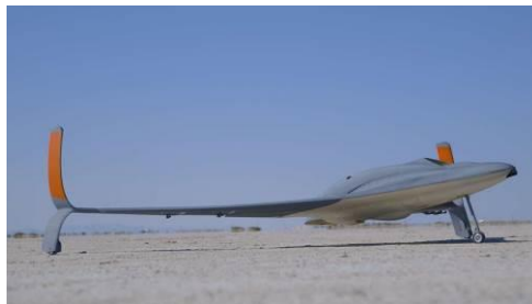
2.44. ábra. 3D-nyomtatott UAV [2.67, 2.68].
