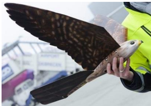
2.46. ábra. A Clear Flight Solution UAV (drón) gép–madara [2.74, 2.75].
