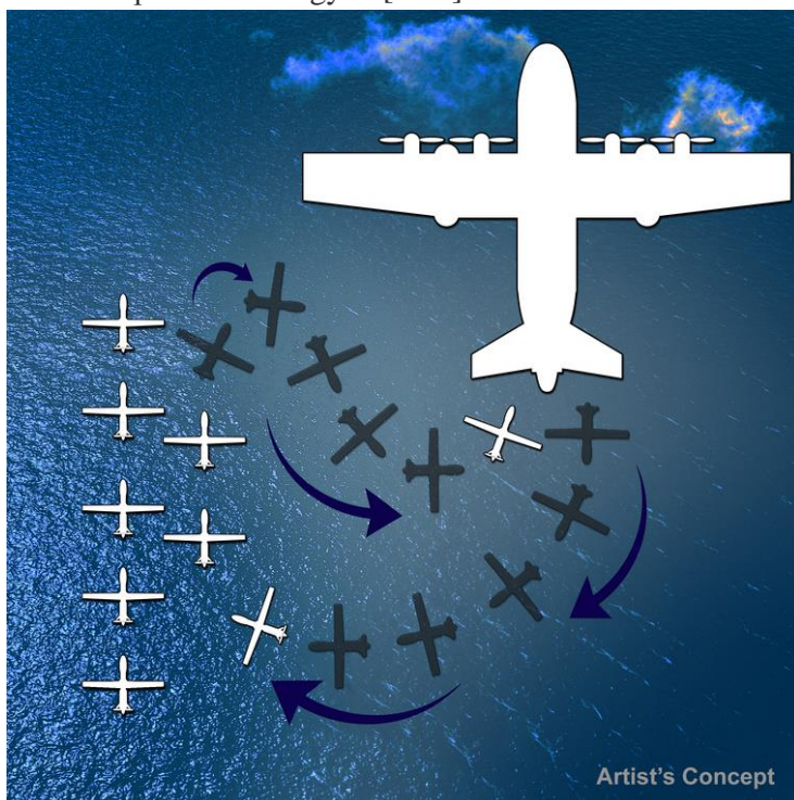
2.40. ábra. UAV indítása és fogadása repülés közben [2.35].
