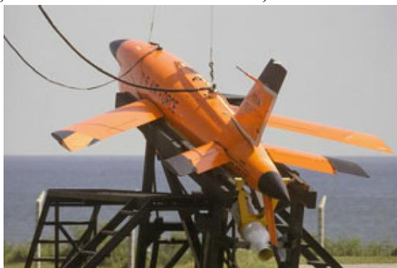
2.21. ábra. Ryan Firebee UAV az indítóállványon [2.41].
