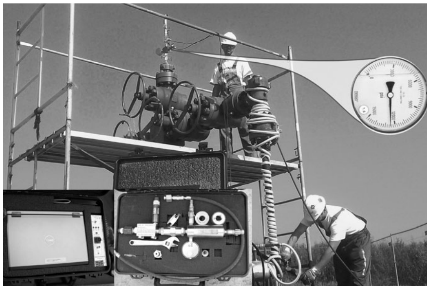
Világviszonylatban egyedülálló kútfejnyomás Makó (Szikáncs) térségében: 876 bar (mélység 6085 méter, rétegyomás 1300 bar, talphőmérséklet 263 °C)
