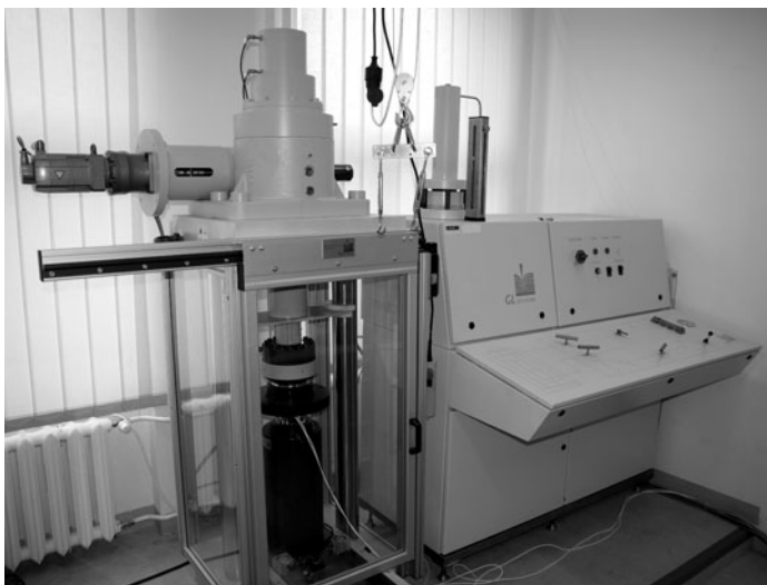
Akusztikus kőzett fizikai mérőberendezés (Miskolci Egyetem Geofizikai Tanszék)
