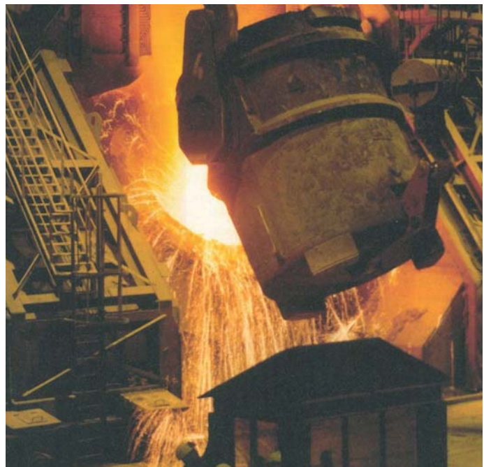
Folyékony nyersvas beöntése az acélgyártó konverterbe
