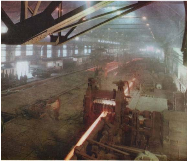
A Közép-hengermű fél-folytatólagos hengersora, amelynek kemence rekuperátorát megépítettük az egyetemi szakdolgozatom alapján
