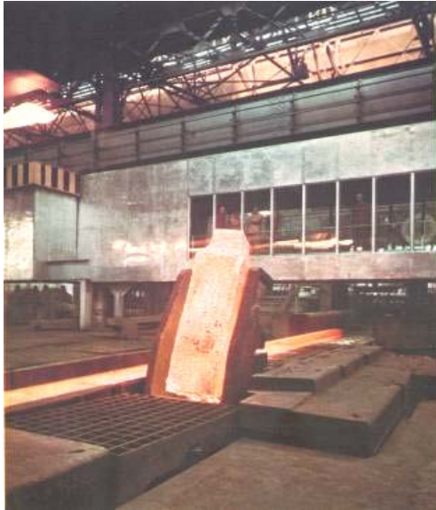
A rekonstruált blokk-sor öntecsfordítója. 1964
