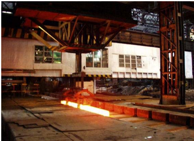
A Blokk-sor 1964-es rekonstrukciója, az öntecsek méretnövelését és gépi mozgatását tette lehetővé
