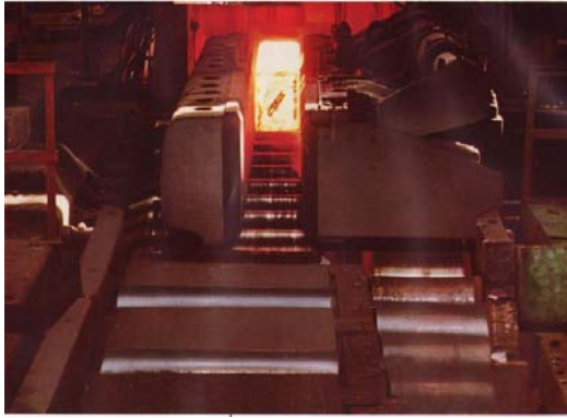
A Blokk-sor 1964-es rekonstrukciója, az öntecsek méretnövelését és gépi mozgatását tette lehetővé
