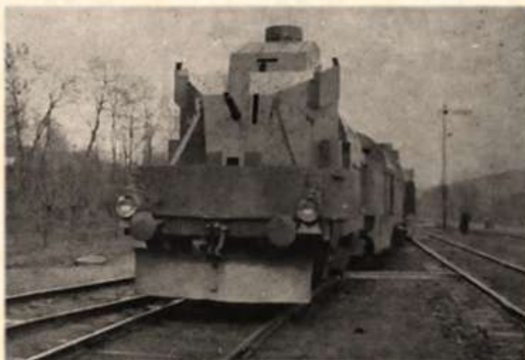
Forgótornyos lövegkocsi hóékével 297
