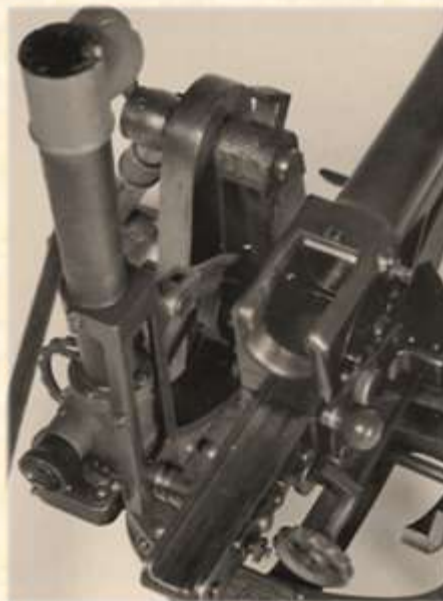
M15/3,7 cm gyalogsági ágyú zárszerkezet, lövegtávcső 397
