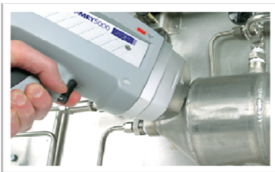
Forrasztási varratok ellenőrzése Oxford X-MET 5000 készülékkel
