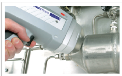
Forrasztási varratok ellenőrzése Oxford X-MET 5000 készülékkel
