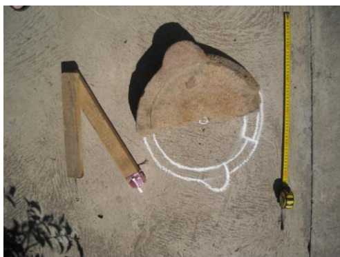
5. Kép: A törött dörzskerék rögtönzött körzövel és mércével
