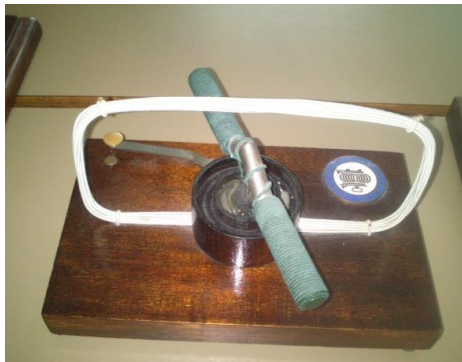
2. ábra: Jedlik elektromágneses forgógya. Magyar Elektrotechnikai Múzeum. Forrás: A képet készítette a szerző (2013)
