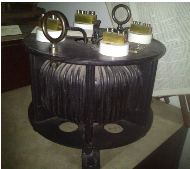
7. kép: Magtípusú transzformátor (vasteste lemezzsalagból csévélty gyűrű), Magyar Műszaki és Közlekedési Múzeum Elektrotechnikai Múzeuma7 Forrás: saját készítés. (2013.07.18.)
