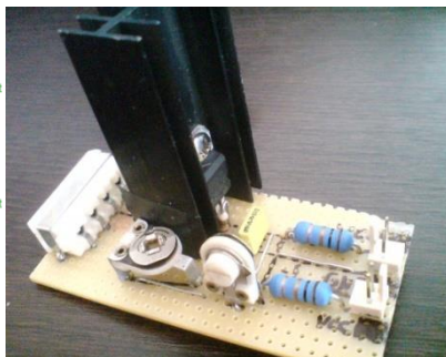
16. ábra: Az akkumulátor töltő kapcsolási rajza (bal oldal), az akkumulátor töltő fizikailag megvalósítva (jobb oldal). Fotó: Bessenyei Szilárd
