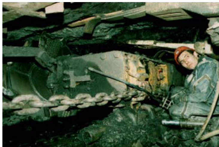
KWB-3DS típusú maróhengeres jövesztő gép a fronton.
