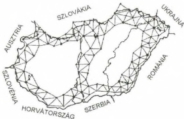
86. ábra. Az új felsőrendű háromszögelési hálózat (1958)
