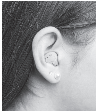
2. ábra. Hallójárat hallókészülék (Forrás: http://test14.jvic.hu/hallokeszulekek.html )
