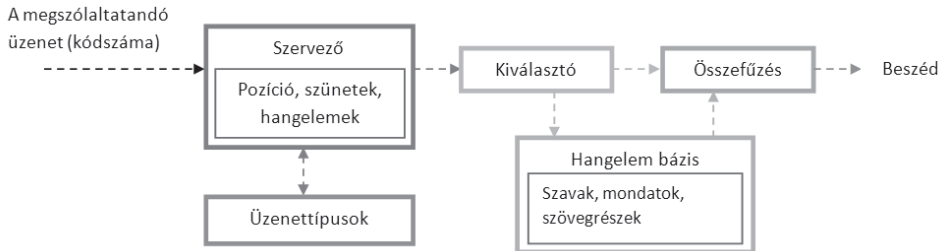
1. ábra. Az általános kötött szótáras beszédszintetizátor blokksémája (Forrás: Pandur 2011: 10)
