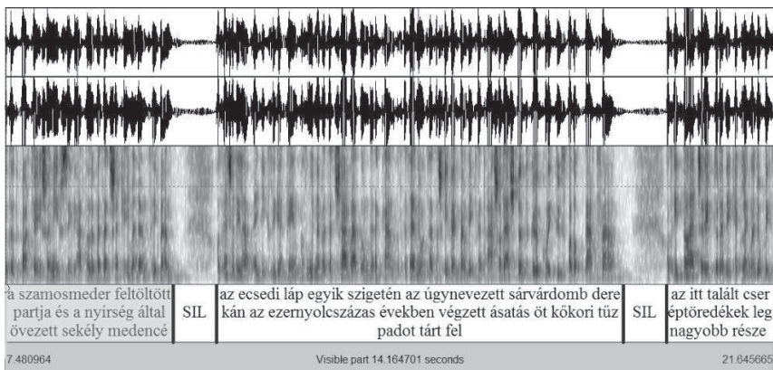
1. ábra. Példa a mondat szintű annotálásra – a kép felső részén az oszcillogramot látjuk, középen a spektrogramot, alul pedig az annotált jelenségeket: jelen esetben a szüneteket (SIL) valamint a mondatokat (PRAAT program)
