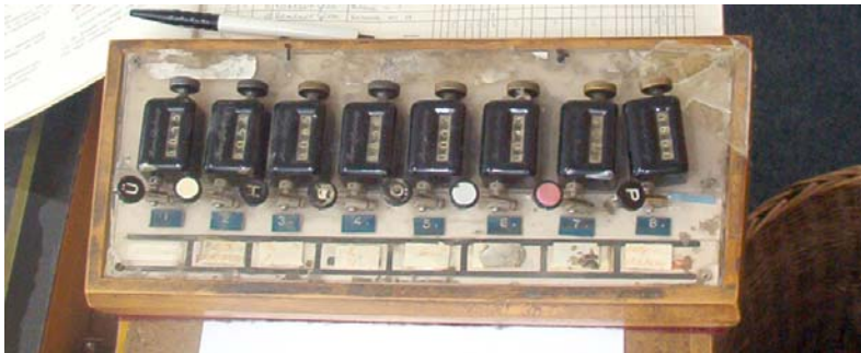
Forgalomszámláló, a „nyomógombos készülék”
