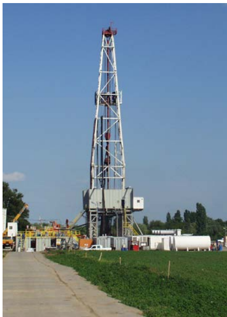
Rig-3 Diesel-elektromos fúróberendezés
