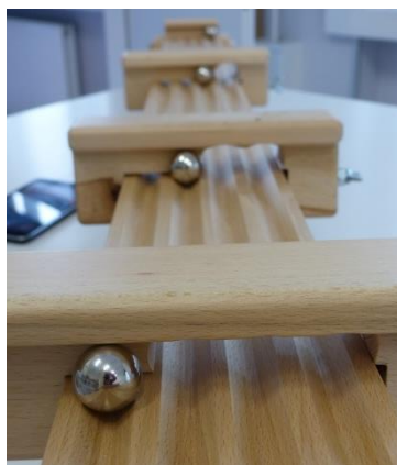
18. ábra Egyenletesen változó mozgás vizsgálata Galilei lejtővel
