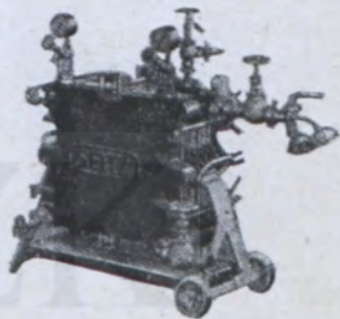
37. ábra. Seitz-féle „Ariston” réteges szűrő.
