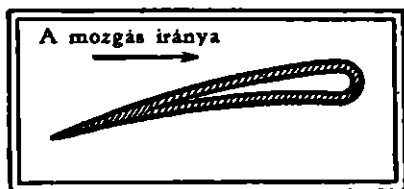
103. rajz. A szárnyak halakú keresztmetszete.
