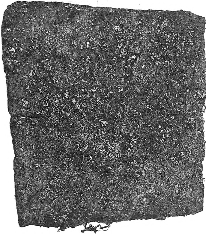
Fig. 20. Querschnitt eines jungen Rohrtorfes („Scheibentorf“).
