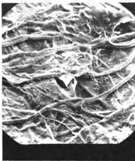
19. Pergamenpéppel készült öntet felületi képe, 300-szoros nagyítás (A 11–19. felvételek Gondár Istvánné /Innovatex Textilipari Kutató/ munkái)
