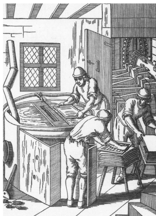
Abb. 1: Papierproduktion mit Schöpfsieb. Holzschnitt von J. A. Endter, 1698
