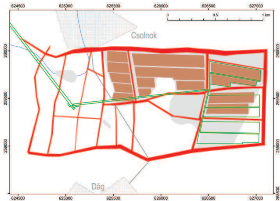
4.56 ábra. Csolnok Új-Borókás terület III. telepének (Tokodi Formáció, „Fornai széntelepes összlet”) fejtési terve
