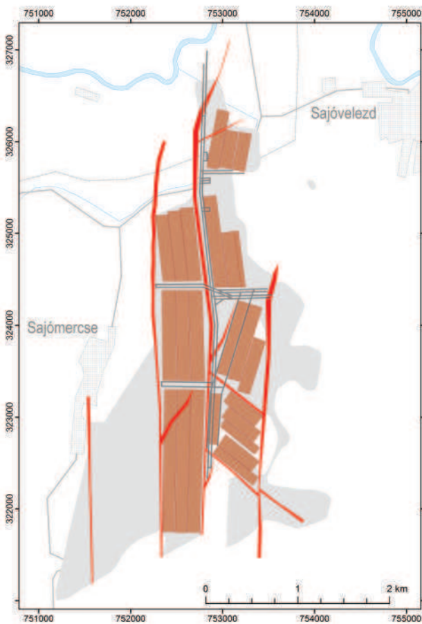
4.18. ábra. Sajómercse I. – Putnok bővítés terület I. telepének fejtési terve a fejtési idomokkal
