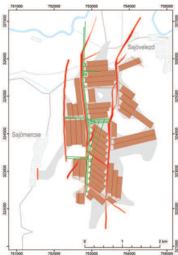
4.20. ábra. Sajómercse II. – Putnok bővítés terület III. telepének fejtési terve a fejtési idomokkal
