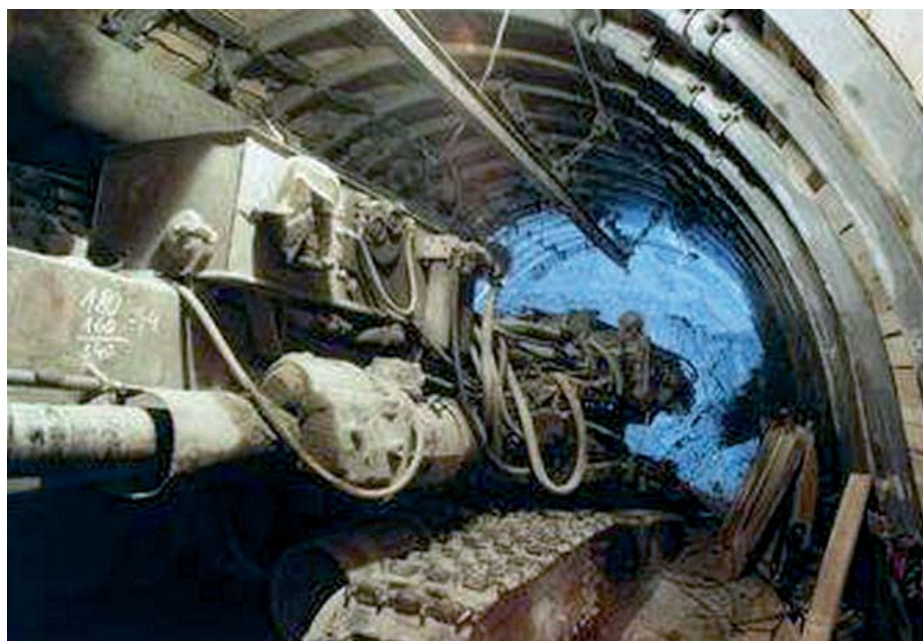
Márkushegy. Vágathajtás Roboterrel.
