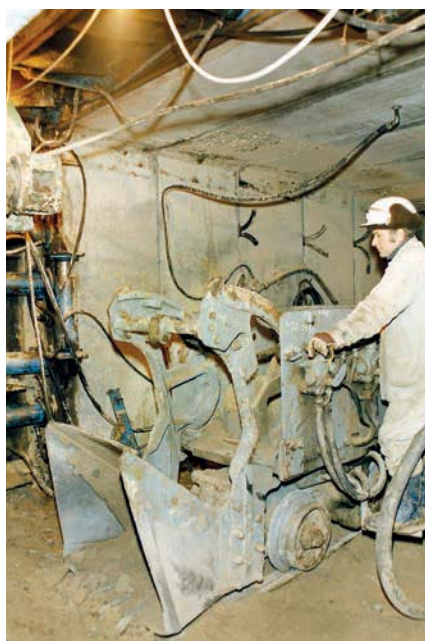
Rakodás négyszög szelvényben.
