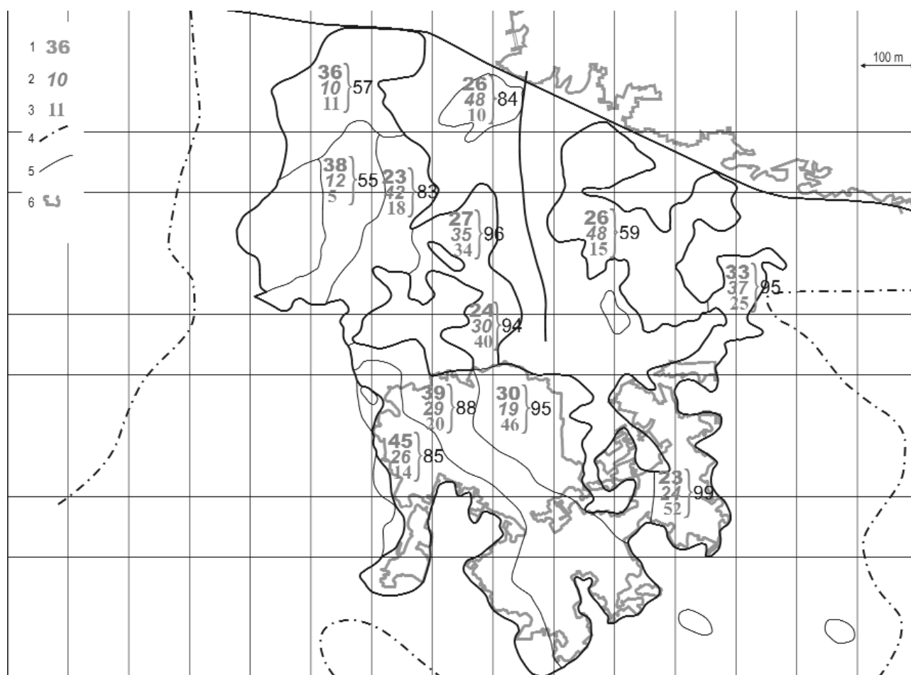
Figure 14. Percentage of the bauxitic rock types within the bauxite sequence in the southern part of the Halimba deposit 1 — Bauxite %, 2 — clayey bauxite %, 3 — bauxitic clay %, 4 — contour of the bauxite sequence, 5 — contours of the sectors, 6 — excavated bauxite 14. ábra. A bauxitos kőzetek vastagságának százalékaránya a bauxitösszletben a halimbai előfordulás déli részén 1 — bauxit %, 2 — agyagos bauxit %, 3 — bauxitos agyag %, 4 — a bauxitösszlet határa, 5 — a részterületek határai, 6 — kitermelt bauxit
