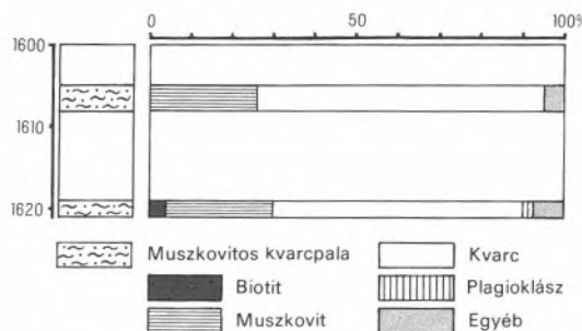
125 A Sósartyán Sós-2 jelű fúrás vizsgálati adatai; muszkovitos kvarcit
