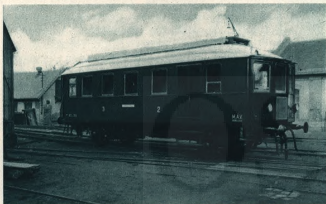
N. A. G. (Nationale Automobil Gesellschaft) gépezetű, BC mot. 350 pályaszámú, kéttengelyű benzol-motorkocsi a helyi érdekű forgalom gyors lebonyolításához. — N. A. G. (Nationale Automobil Gesellschaft) Zweiachsiger Benzol-motorwagen No. 350. mit BC Motormaschinerie. Zur schnellen Abwicklung des Lokalverkehrs. — Wagon-moteur à benzol, à deux essieux, an No. de marche BC mot. 350., fabrication N. A. G. (Nationale Automobil Gesellschaft) Au prompt desservage du trafic local. — Benzol-motor-car N. A. G. (Nationale Automobil Gesellschaft) BC mot. No. 350 with two axles for the rapid execution of local traffic.
