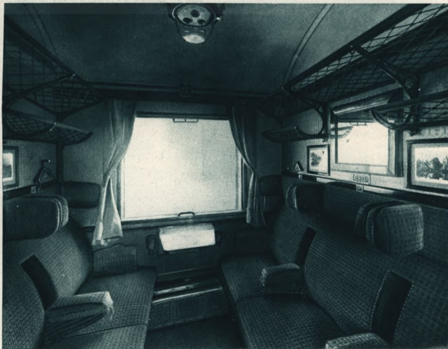
Vasvázis négytengelyű I.-II. oszt. kocsik I oszt. szakasza (1927.). Új kocsik nemzetközi gyorsvonatok részére. — Abteil I. Klasse der Wagen I.-II. Klasse mit Eisengerippe und 4 Achsen, (1927) Neue Wagen zu internationalen Eilzügen. — Compartiment de Ie classe d'un wagon de Ie-IIe classe, à quatre essieux, armature de fer (1927.). Voitures neuves pour trains internationaux. — I. Class-compartment of a I-II. Class-waggon with iron-frame and four axles (1927) New waggons for international express trains.
