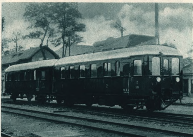
Ganz-gyártmányú, BC Mot. 351. pályaszámú, kéttengelyű benzin-motorkocsi a helyi érdekű forgalom gyors lebonyolításához. — Zweiachsiger Benzinmotorwagen No. 351 mit BC-Motorfabrikat „Ganz“ Zur schnellen Ahwicklung des Lokalverkehrs. — Wagon-moteur à essence, à deux essieux, an No. de marche BC mot. 351., fabrication „Ganz“ S. A. Au prompt desservage du trafic local. — Benzin-motor-car of the Ganz factory BC mot. No. 351., with 2 axles for the rapid execution of local traffic.
