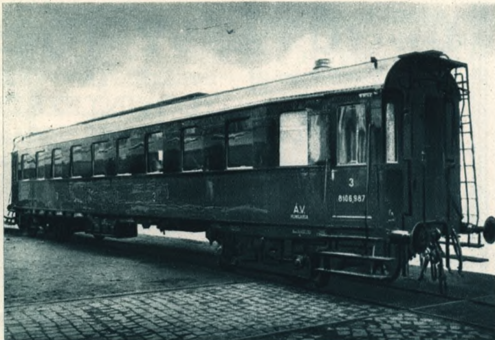
Vasvázás négytengelyű III. oszt. kocsí. (1925.) Uj kocsik nemzetközi gyorsvonatok részére. — Wagen III. Klasse mit Eisengerippe und 4 Achsen. (1925.) Neue Wagen zu internationalen Eilzügen. — Wagon de IIIe classe, à quatre essieux armature de fer. (1925.) Voitures neuves pour trains internationaux. — III Class-waggon with iron-frame and four axles. (1925.) New waggons for international express trains.
