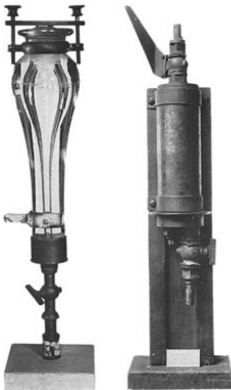
Üveg és fém eudiométer, amelyekkel Cavendish felfedezte a víz összetételét
