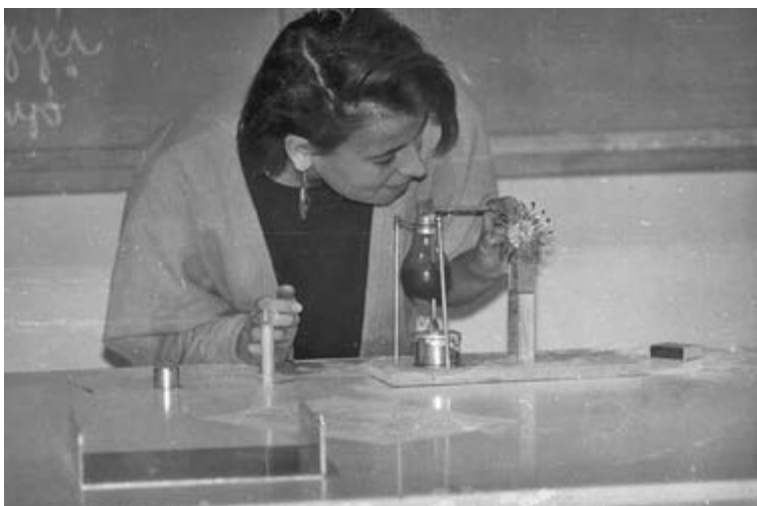
Gőzturbina-modell bemutatása az Öveges-délutánon Szombathelyen, a BDTF-en
