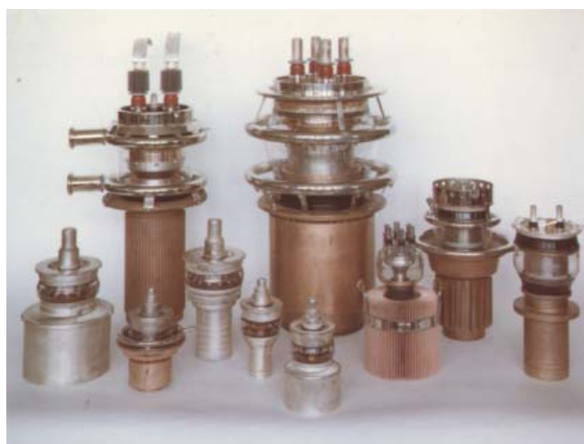
Felül: az Egyesült Izzó egykor volt Adócsőgyárának Váci úti épülete, alul: a befejezés éveinek legmodernebb termékei, a kerámia szigetelésű kisadócsövek
