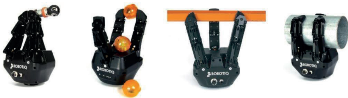
4. ábra: A Robotiq háromujjas megfogójának fogástípusai
