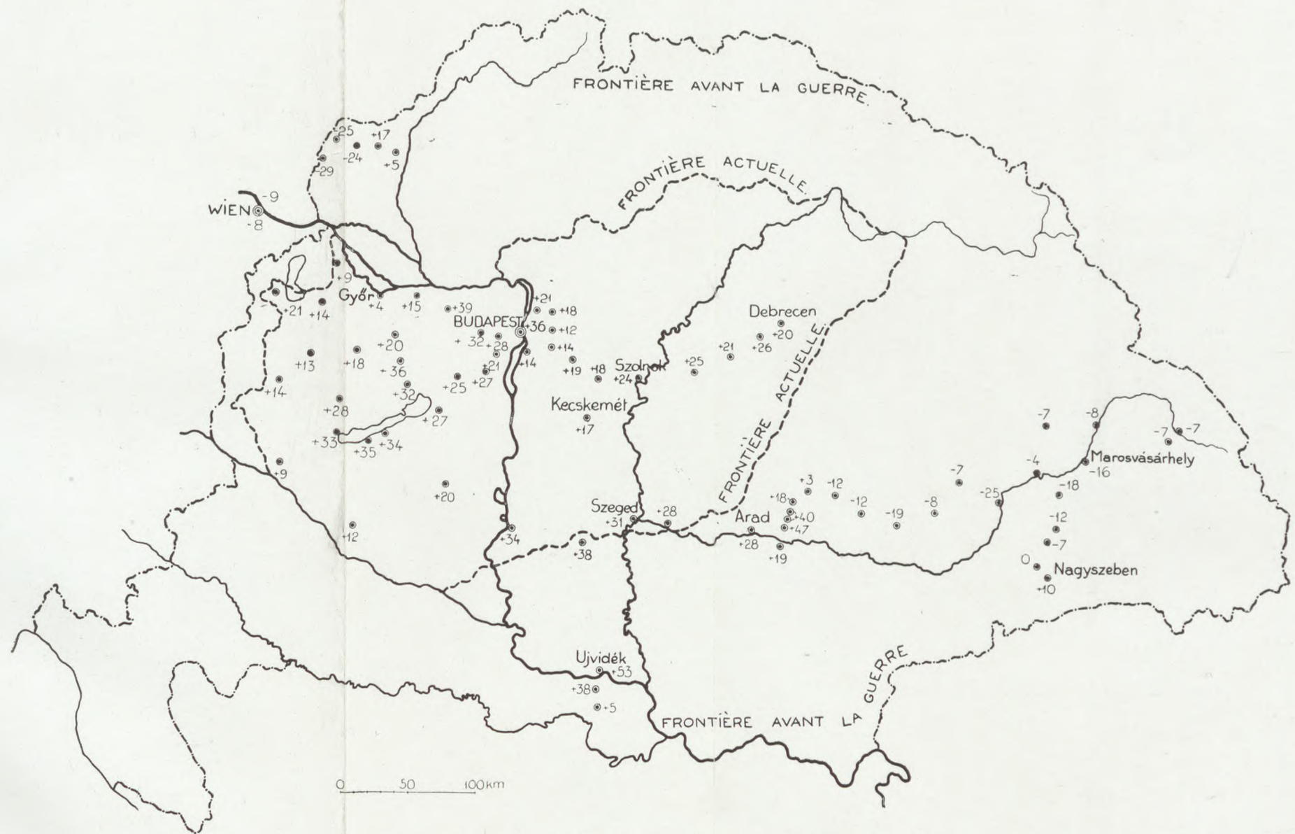
14. ábra. Az ingamérésekből megállapított ( g_0' - \gamma_0 ) gravitációs rendellenességek.
