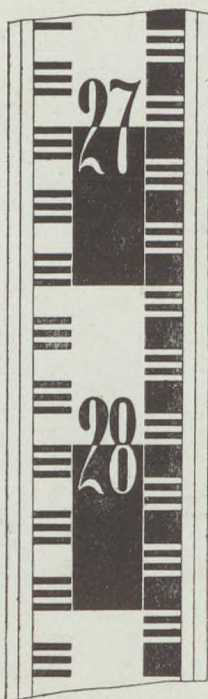
13. ábra. A Seibt-féle szintező lécz beosztása és számozása.
