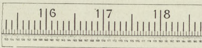
30. ábra. A Goulier-féle színtező lécbesztása.
